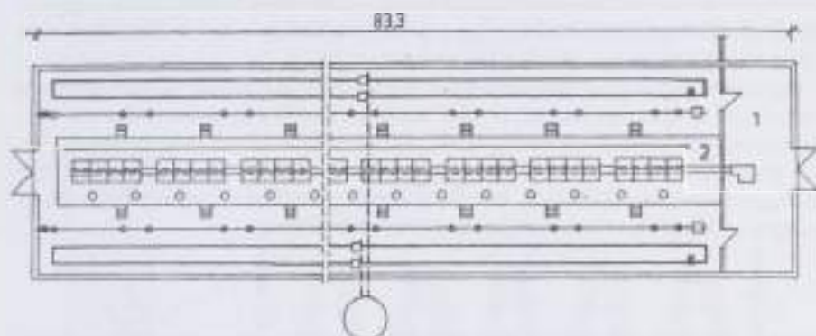
630 ábra. Mélyalmos brojlersarke istálló keresztmetszete (1 mélyalmos felület, 2 köretető, 3 túlfolyós itató, 4 szellőző csatorna)
