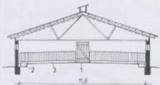
643. ábra. Hagyományos (önetetőkből – száraztakarmányozású, almozás nélküli) sertésistálló rekonstrukciójaként kialakított zárt keresztvályús, almozható, mobil gépes nedvestakarmányozású és stabil gépes trágyaelváltású középkezelő utas hízoló keresztmetszetének vázlata (1 kezelőút, 2 nyitott trágyacsatorna, 3 keresztvályú)
