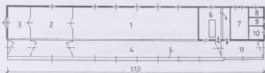
635. ábra. Zárt kötött tartású kisüzemi tehenistálló (1 tehenállások, 2 borjak, 3 2-6 hónapos borjak, 4 ösők, 5 tejkezelő, 6 takarmányos, 7 gépház, 8 etetésasztal, 9 kezelőtűt)
