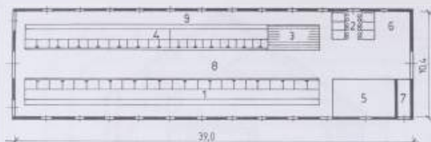
635. ábra. Zárt kötött tartású kisüzemi tehenistálló (1 tehenállások, 2 borjak, 3 2-6 hónapos borjak, 4 ösők, 5 tejkezelő, 6 takarmányos, 7 gépház, 8 etetésasztal, 9 kezelőtűt)
